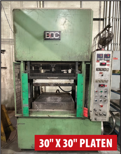
BDC 300 TON COMPRESSION MOLDING PRESS
