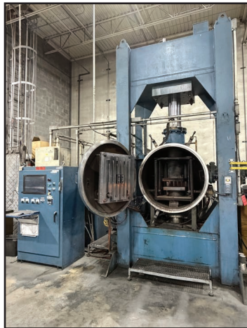
AVS VHP 16X16-500T-482 500 TON VACUUM PRESS
